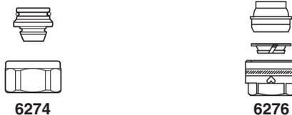
Klemmsset metallisch dichtend. **Nicht** einsetzbar für verchromte Metall- und Edelstahlrohre
